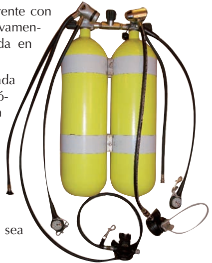
Figura 2.27 La distribución de las conexiones a cada regulador, la longitud de sus manguitos y sus sistemas de fijación no se debe dejar al azar hay que buscar la mejor opción.
