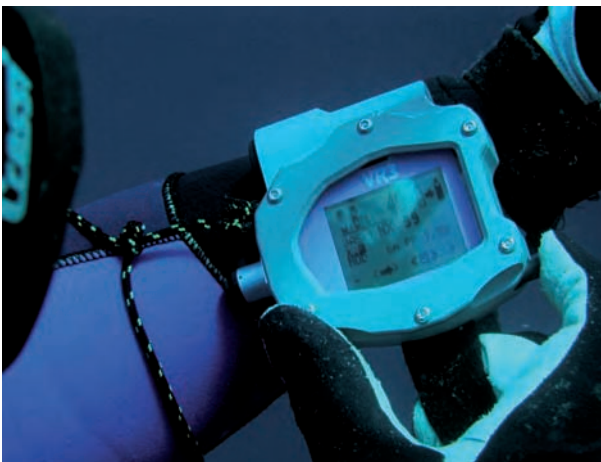
Figura 1.10 Cambiando de mezcla según subimos.
