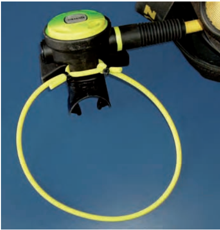
Figura 1.3 Regulador en servicio de oxígeno preparado para utilizarlo.
