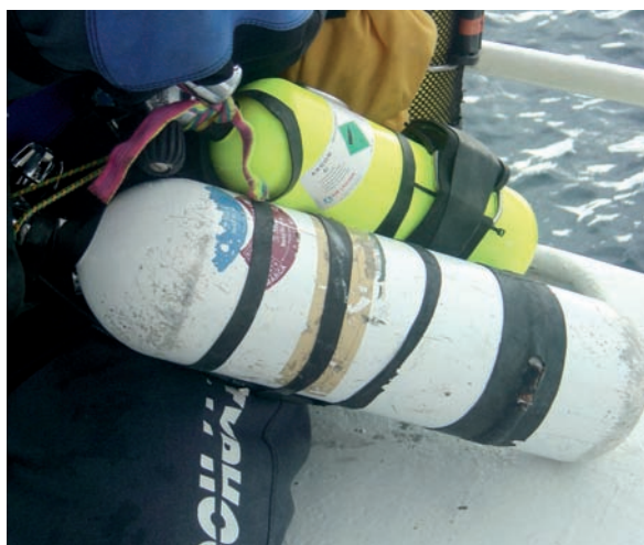
Figura 2.28 La botella de argón se utiliza para inflar el traje seco.
